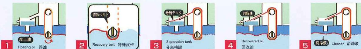
各種切削タンクや洗浄槽に浮上する浮上油を、特殊開発のベルトで回収し、加工精度の向上・切削液の腐敗劣化防止・洗浄精度の向上に貢献します。ベルトが液中に入る時に、浮上油を付着させていくのが特長です。また、洗浄機用 TB-75 型は切削油を洗い落として汚れた液及び浮上油を早く多く回収するような特殊ベルトを、クーラント用 RB-200 型は潤滑油等の浮上油を効率よく回収する特殊ベルトを用いております。
